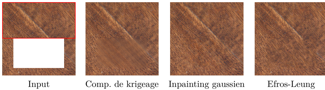
FIGURE 2.15 – Comparaison avec Efros-Leung [Efros and Leung, 1999]. L'image d'entrée est inpaintée à l'aide du modèle gaussien appris sur le rectangle rouge. Comme on peut l'observer, notre algorithme préserve mieux le contenu fréquentiel de la texture grâce notamment au prolongement des structures apporté par la composante de krigeage.
